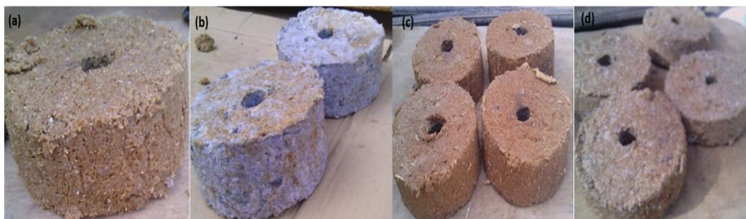
Figure 5. (a) Rice Husk Briquette (b) Paper Briquette (c) Saw dust Briquette (d) 50% Rice husk + 50% Paper Briquette
