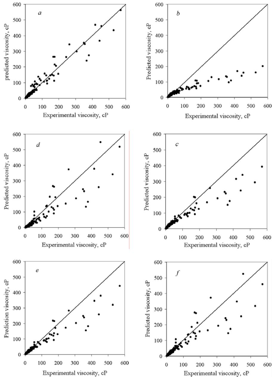
Fig. 2: Scatter diagrams, a) this work, b) Naseri et al., c) Glasø, d) Beal, e) Kartoatmodjo, and f) modified Kartoatmodjo.
